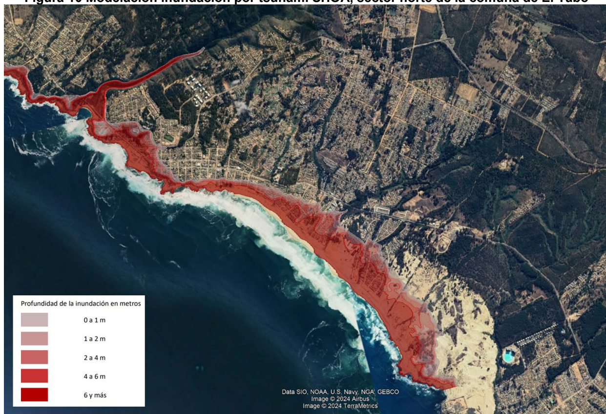
Figura 10 Modelación inundación por tsunami SHOA, sector norte de la comuna de El Tabo
